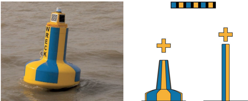
Boya de emergencia para señalización de naufragios (EWMB).
